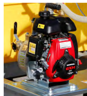
Pompa a motore HONDA 130l/min
