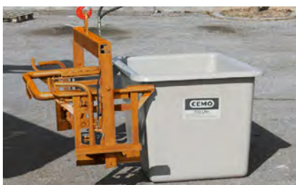
Inserimento della staffa di carico lateralmente dopo la rimozione del coperchio rimovibile (esempio con contenitore per materiali da spargere di 700 l)
