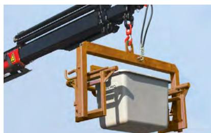
Sollevamento del contenitore (esempio con contenitore da 200 l)
