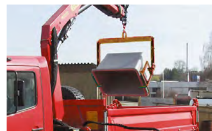
Svuotamento del materiale da spargere sulla piattaforma del camion (esempio con contenitore da 700 l)
