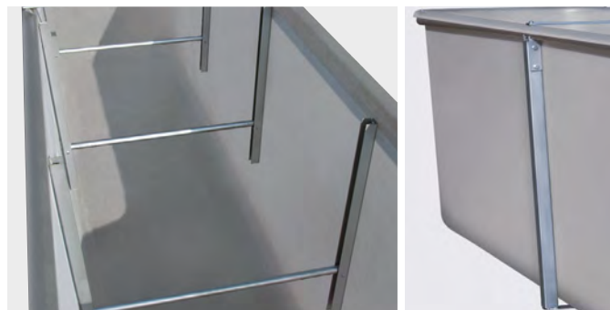
Contenitori grandi: Sostegni interni in acciaio inox per l'installazione interrata. Sostegni esterni zincati a caldo per l'installazione in superficie
