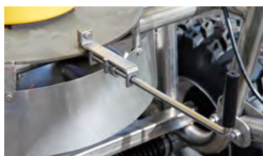
Controllo della quantità di spargimento
