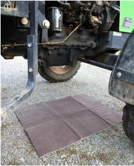
Applicazione del tappeto assorbente olio del kit d'emergenza Agrar
