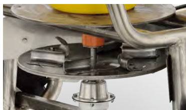
Mola di spargimento in acciaio inox, regolabile
