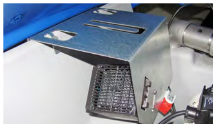
CUBE AdBlue®, riscaldamento con termostato
